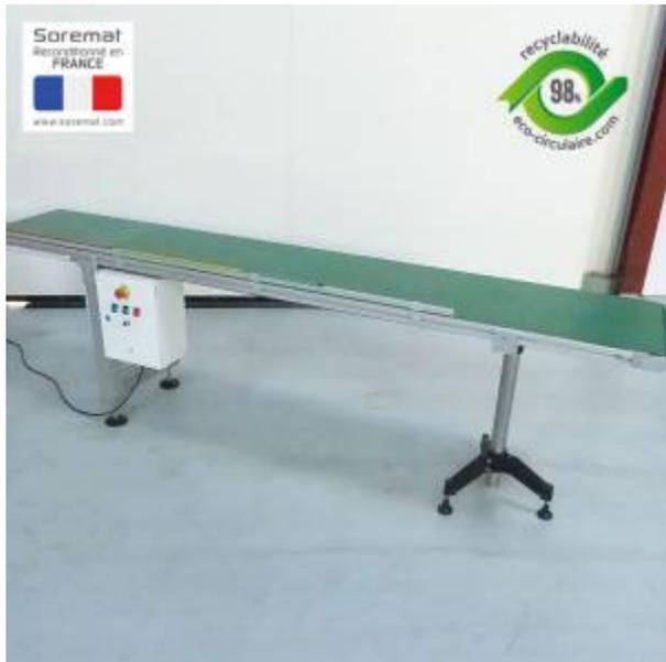
**ADMV Convoyeur à bande lisse largeur 490 x 2900mm+
