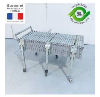
Convoyeur à rouleau accordéon - extensible de de 1070 mm a 3120 mm
