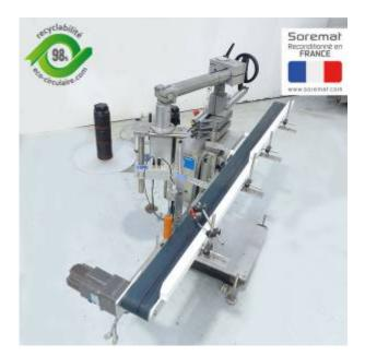
HERMA Etiqueteuse type 452C avec tete H400 16R de pose avec convoyeur
