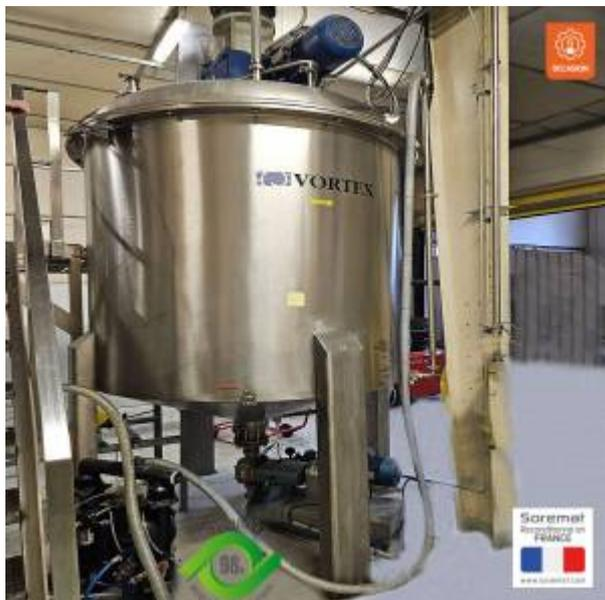
**3000 L VORTEX Cuve simple enveloppee inox avec agitation centrale**
